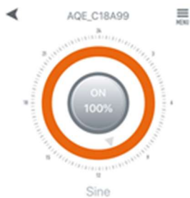
Fig. 26: ... quindi toccare il simbolo dell'onda davanti a "Modalità classica" e selezionare "Flusso incrociato" (viene quindi evidenziato in blu). La potenza della pompa viene regolata in "Flusso", il tempo di accensione e spegnimento con "Frequenza" (minimo circa 30 secondi, massimo circa 90 minuti). Salvare con "OK" e "Salva". Possano essere necessari fino a tre cicli affinché le pompe "trovino" il loro ritmo di alternanza. Dovresti quindi iniziare con un ciclo al livello più basso e aumentarlo quando le pompe cambiano in modo uniforme.
