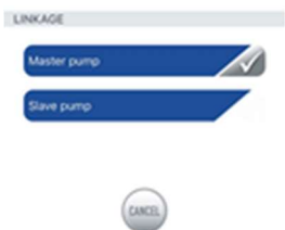
Abb. 20: In diesem Einstellmenü kann festgelegt werden, ob eine Pumpe als Master oder Slave arbeitet. Es kann nur eine Pumpe im Master-Betrieb arbeiten. Mehrere „MASTER“-Pumpen im selben Empfangsbereich führen zu unerwünschten Wechselwirkungen.
