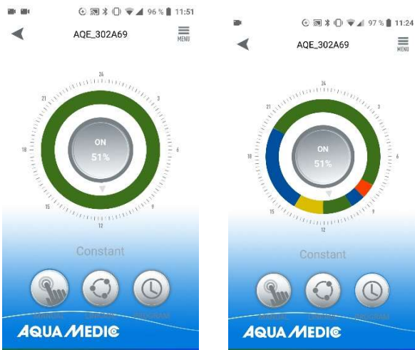
Fig. 19: Per attivare un programma che è stato creato, è necessario toccare brevemente il pulsante PROGRAM. Il display passa quindi al programma creato.
