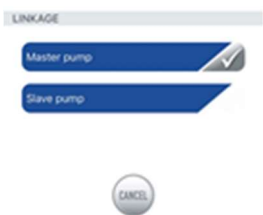
Рис. 20: В этом меню настройки можно определить, работает ли насос в режиме ведущего или ведомого. В режиме ведущего может работать только один насос. Несколько насосов "MASTER" в одной зоне приема приводят к нежелательному взаимодействию.
