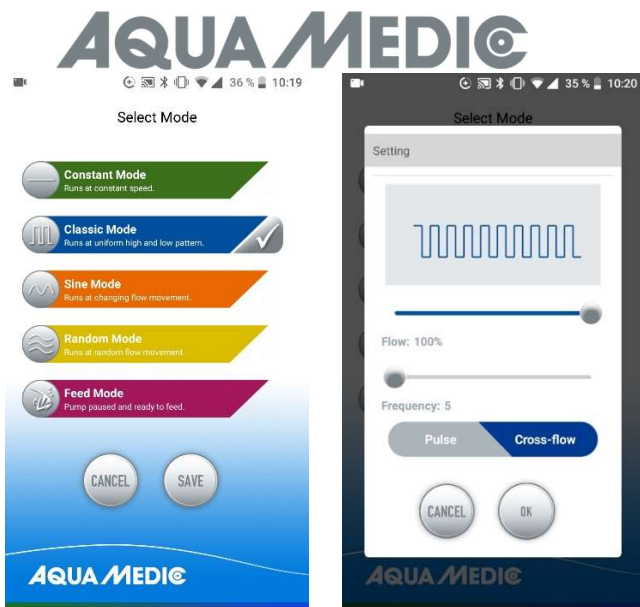
Fig. 26: ... quindi toccare il simbolo dell'onda davanti a "Modalità classica" e selezionare "Flusso incrociato" (viene quindi evidenziato in blu). La potenza della pompa viene regolata in "Flusso", il tempo di accensione e spegnimento con "Frequenza" (minimo circa 30 secondi, massimo circa 90 minuti). Salvare con "OK" e "Salva". Possano essere necessari fino a tre cicli affinché le pompe "trovino" il loro ritmo di alternanza. Dovresti quindi iniziare con un ciclo al livello più basso e aumentarlo quando le pompe cambiano in modo uniforme.
