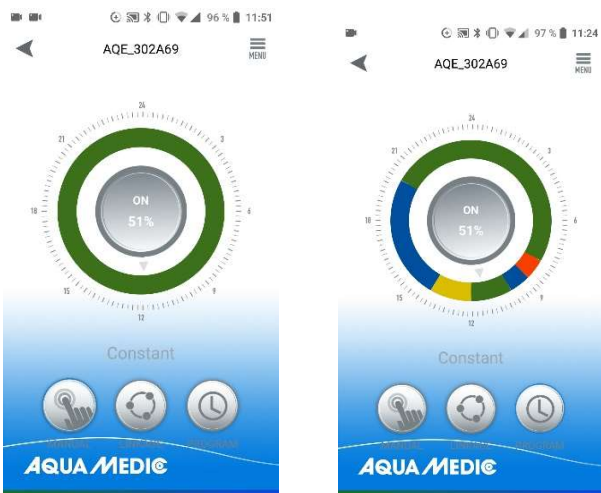
Rys. 19: Aby aktywować utworzony program, należy krótko dotknąć przycisku PROGRAM. Na wyświetlaczu pojawi się utworzony program.
