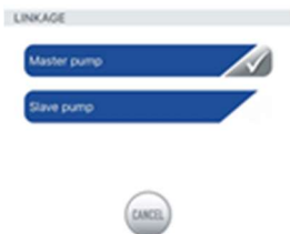
Fig. 20: In dit menu, kan er bepaald worden of een pomp zal werken als master of slave. Slechts 1 pomp kan werken in master mode. Meerdere "MASTER" pompen in hetzelfde gebied zal leiden tot ongewenste interacties.
