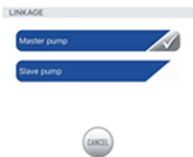
Fig. 20 : Dans ce menu de réglage, il est possible de déterminer si une pompe fonctionne en tant que maître ou esclave. Une seule pompe peut fonctionner en mode maître. Plusieurs pompes «MASTER» dans la même zone de réception conduisent à des interactions indésirables.
