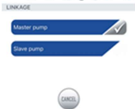
Fig. 20: In questo menu è possibile determinare se una pompa funziona come master o slave. Solo una pompa può funzionare in modalità master. Diverse pompe "MASTER" nella stessa area provocano interazioni indesiderate.
