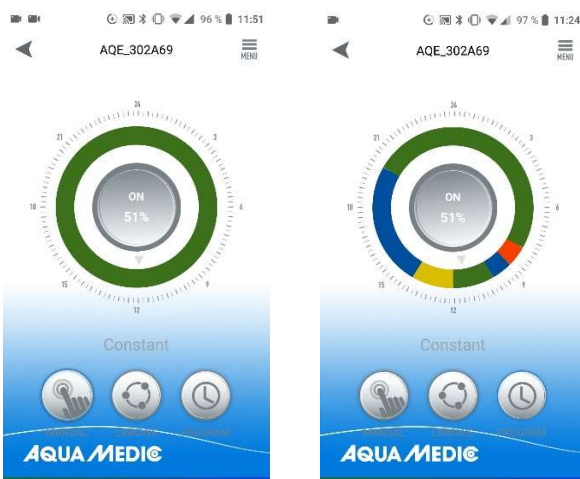
Abb. 19: Um ein erstelltes Programm zu aktivieren, muss kurz der PROGRAM Button angetippt werden. Die Anzeige wechselt dann auf das erstellte Programm.
