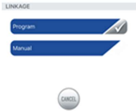
Fig. 21: Se puede establecer un modo de programa o un modo manual para la bomba "MAESTRO" El ajuste se hace como descrito en el modo manual o en el modo temporizador.
